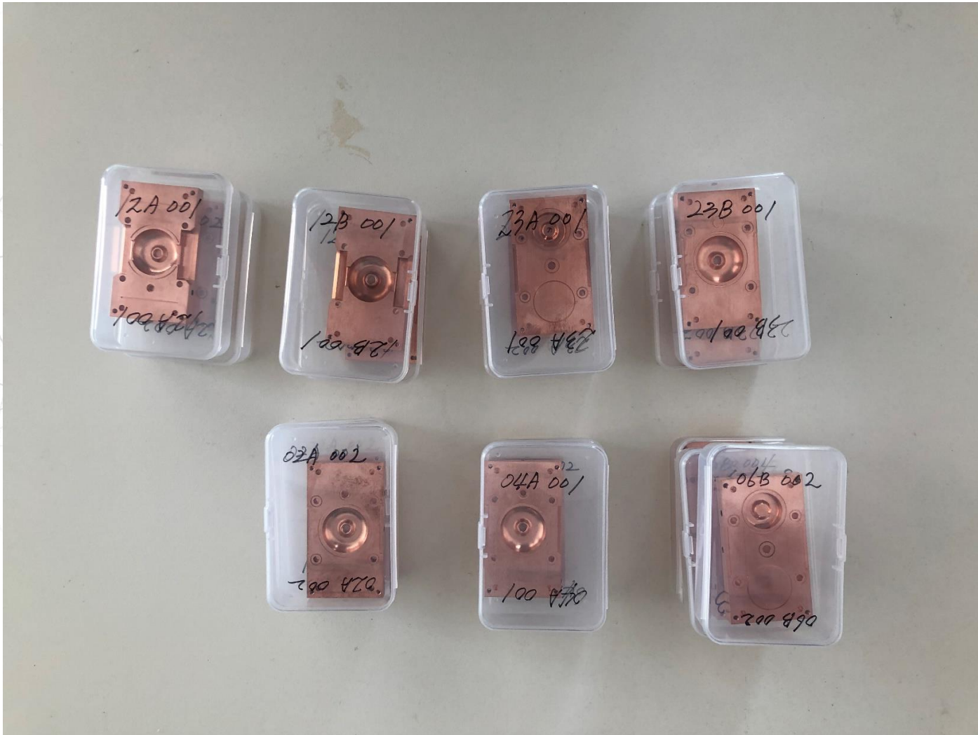
(a) 황삭 (오차 ~ 1 \mu\text{m} ) 가공진행 중인 RF Cavity cells (21.06.)
